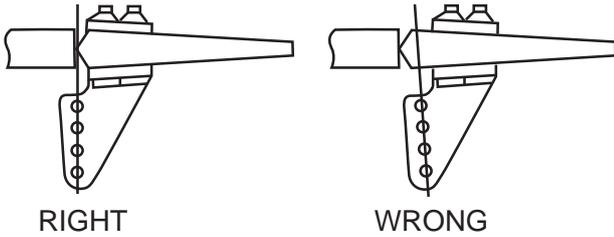
**INSTALLING THE AILERON LINKAGES**
