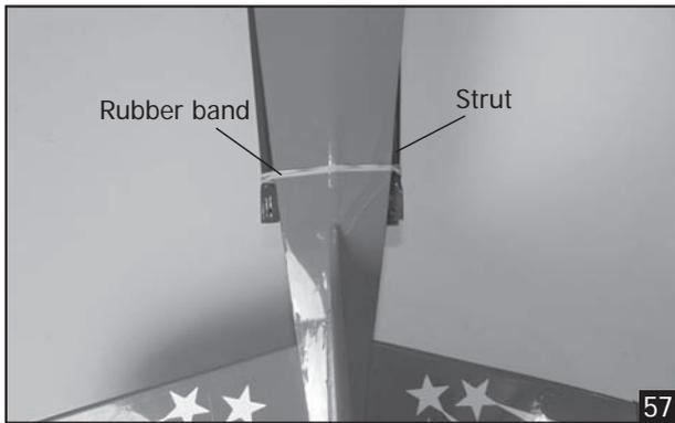
**INSTALLING THE PILOT**
