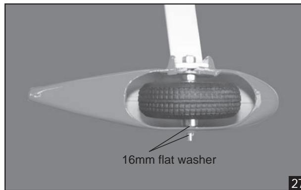
**INSTALLING THE WHEEL PANTS**
