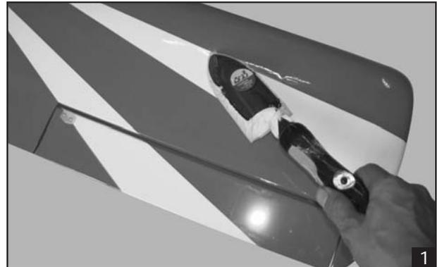
**INSTALLING THE AILERONS**
